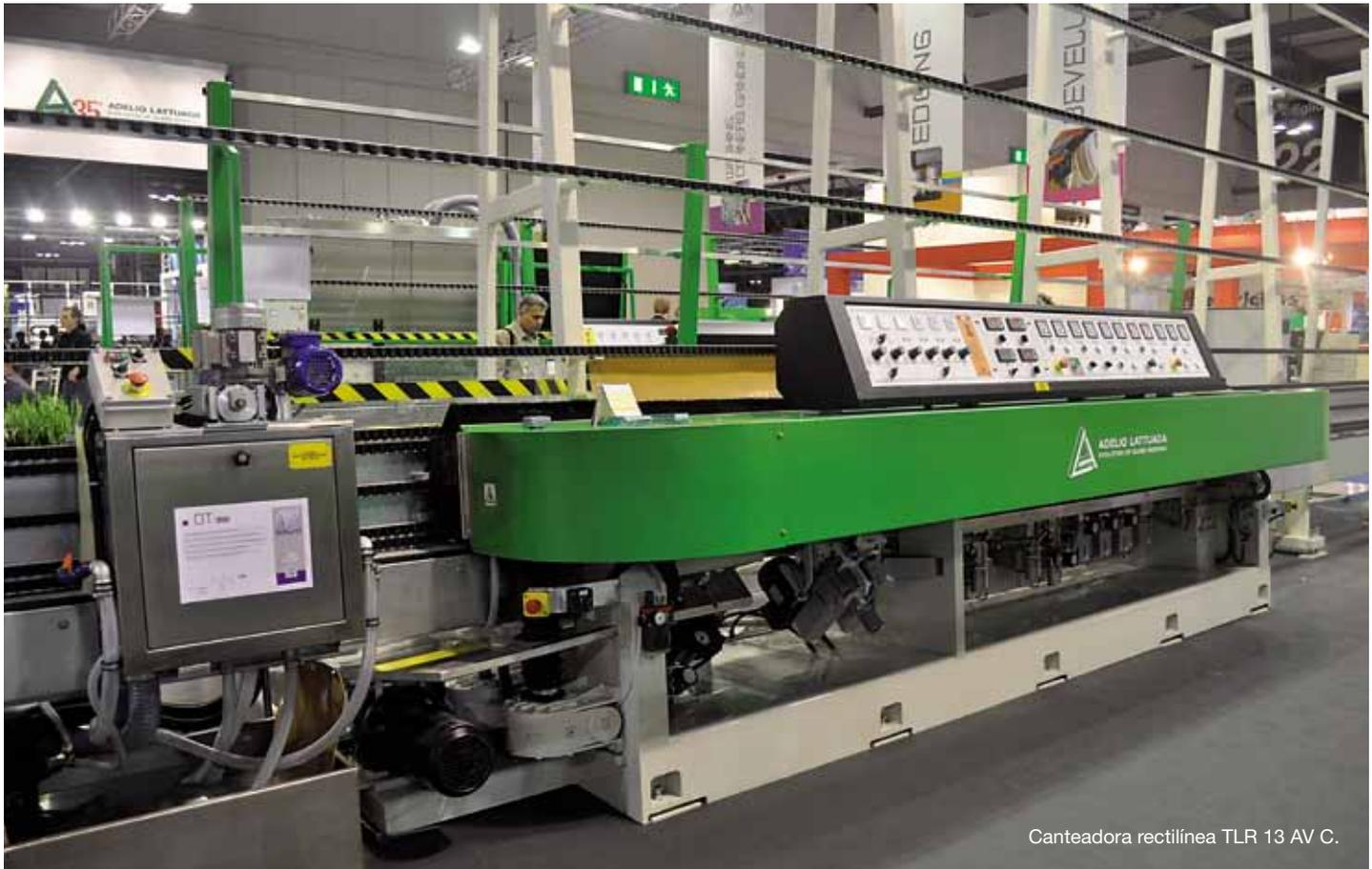
Canteadora rectilínea TLR 13 AV C.
