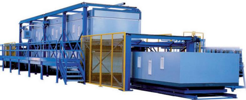
Ligne de bombage automatique à haute productivité TKB-T permet la production de verres incurvés, avec une périodicité de 30-40 min par chariot. La ligne TKB-T est utilisée pour la production de verres pour secteur de l'automobile, de la marine et de l'architecture. Le système de contrôle de la température permet de satisfaire quelque exigence de bombage. Chaque programme de bombage peut être mémorisé et puis réutilisée pour des productions ultérieures.
