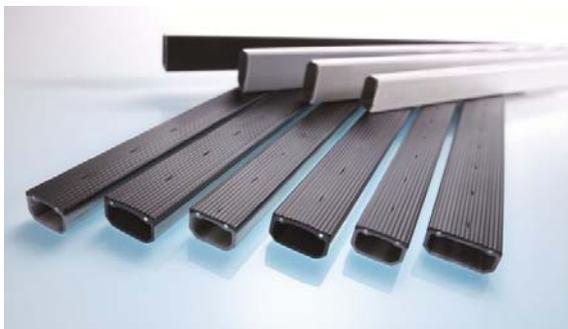
Thermix Abstandhalter bestehen aus einem UV-beständigen Spezialkunststoff, der eine mehr als 700fach geringere Wärmeleitfähigkeit als Aluminium besitzt. Eine 0,1 mm dünne, gas- und wasserdampfdichte Edelstahl-Folie auf dem Hohlkammerprofil sorgt für die dauerhafte Abdichtung des Scheibenzwischenraums.
